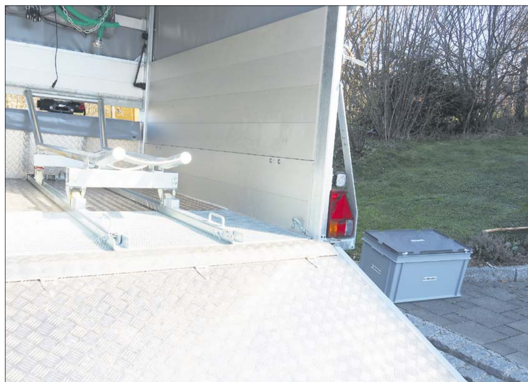
Blick in den Spezialanhänger, den so genannten T-Trailer, mit dem Schragen zum Transport betäubter und entbluteter Rinder.
